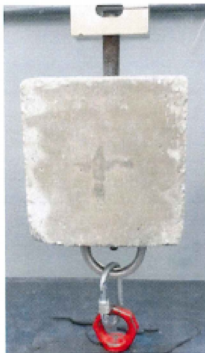
FIGURA N.º 05 – AMOSTRA L-157645/S2 ANTES DO ENSAIO DE RESISTÊNCIA ESTÁTICA.
